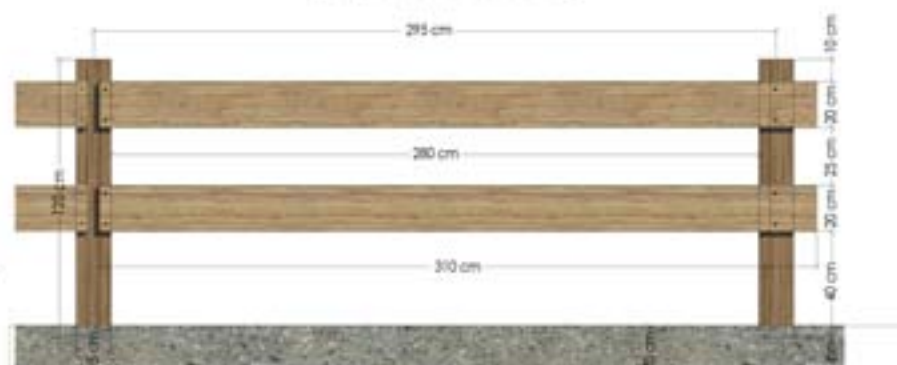
Prospetto della staccionata
